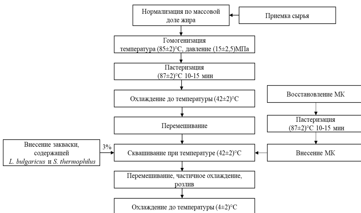
Рисунок 14 – Принципиальная технологическая схема производства продукта кисломолочного с МК
